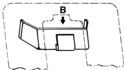
Die HEINE-Fixationskarten für die dynamische Skiaskopie werden mit Hilfe einer speziellen Halterung auf dem Skiaskop befestigt.
